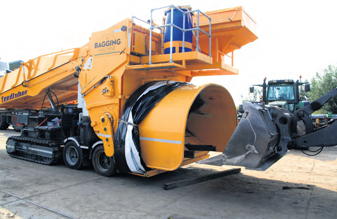
Achter op de Feedtuber staan een vat voor de Microferm en een bak voor de Bokamix, het mengsel van kalk en kleimineralen.
