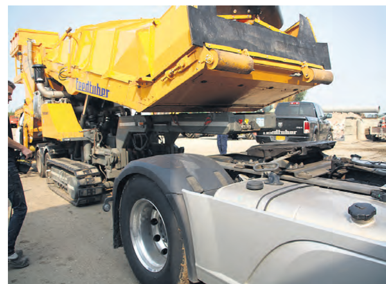
De Bagging Machine van Feedtuber kan als een trailer aan de truck worden gekoppeld om overal in Nederland te kunnen werken.
